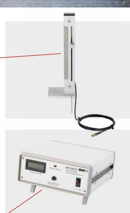
La jauge électronique à eau permet de mesurer le niveau d'eau dans un canal ouvert. Elle est fixée à l'endroit souhaité sur la paroi latérale du canal. La hauteur du niveau d'eau est déterminée au moyen d'une sonde que l'on déplace. La position de cette sonde peut aussi bien être lue directement sur l'échelle la jauge à eau ou affichée numériquement sur l'appareil principal.
