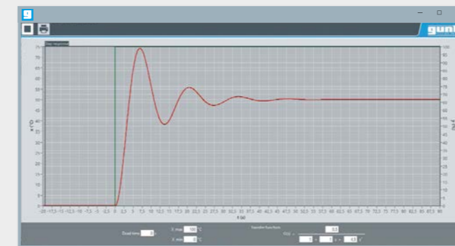
Système réglé avec comportement PT 2
