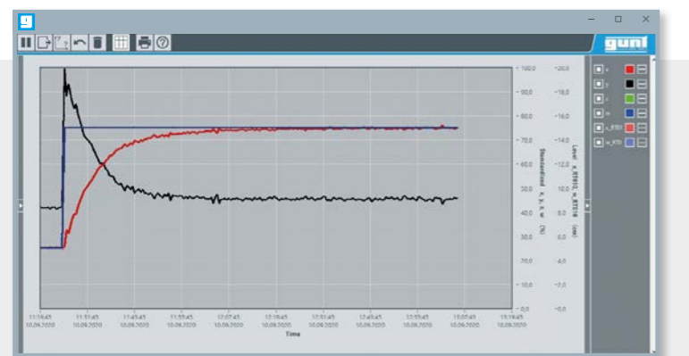
Füllstandsregelung mit PID-Regler, Führungsgrößensprung
