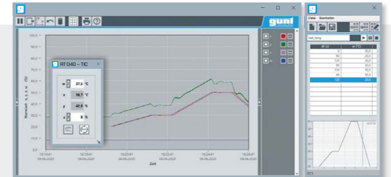
Programmablauf mit vorgegebenen Zeitabschnitten und Führungsgrößen
