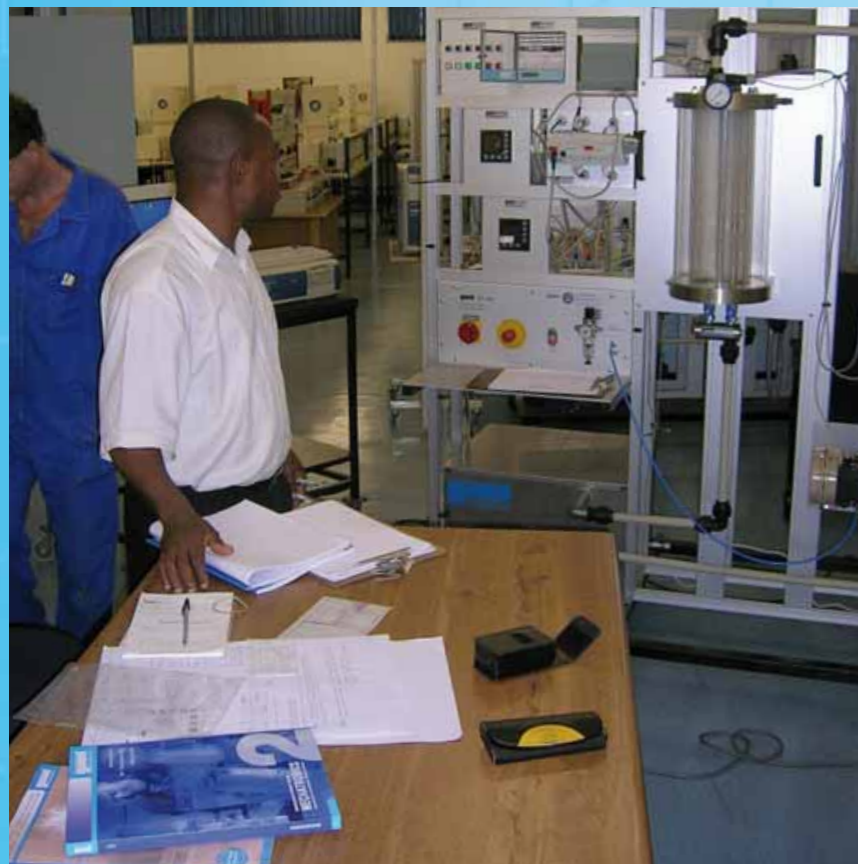
Régulation de niveau avec un régulateur continu ou un API
