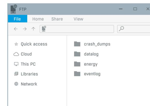
mit der IP-Adresse des Versuchsgerätes kann mittels FTP-Server auf Messdatensätze zugegriffen werden, die während des Versuches intern oder über USB-Stick gespeichert wurden
