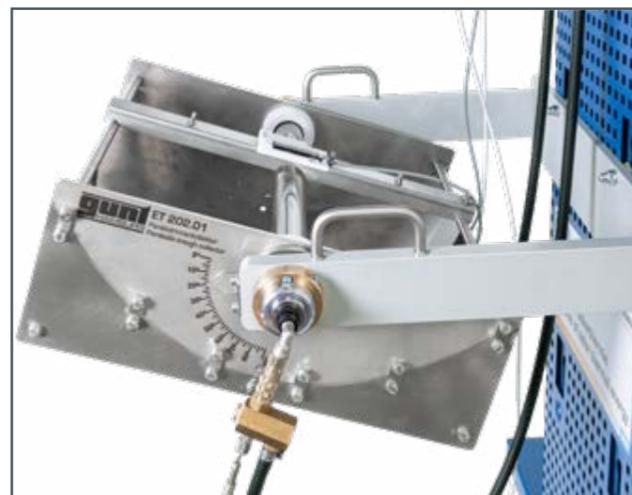
capteur cylindro-parabolique pivotant
