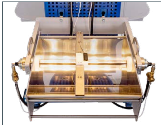
ET 202.01 beleuchtet mit der Lichtquelle von ET 202
