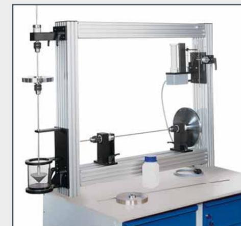
Les **vibrations de torsion** jouent un rôle important dans les systèmes d'entraînement et doivent être contrôlées pour éviter tout dommage. Le jeu d'accessoires TM 150.02 permet de générer des **vibrations de torsion libres et amorties**, et d'étudier l'influence de la rigidité en torsion, de la masse et de l'amortissement sur la fréquence et l'amplitude.
