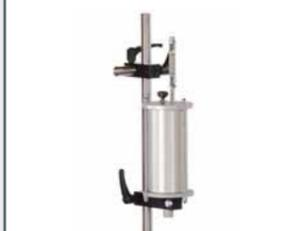
**Vibrations amorties** par des amortisseurs visqueux ajustables ayant un frottement de Coulomb très faible
