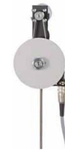
Absorbeur de vibrations réglable pour l'étude des effets d'absorption
