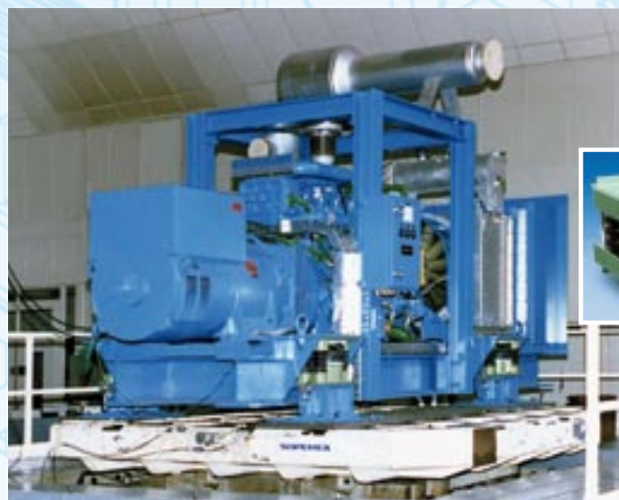
Isolation antivibratile par ressorts hélicoïdaux Source: www.gerb.com
