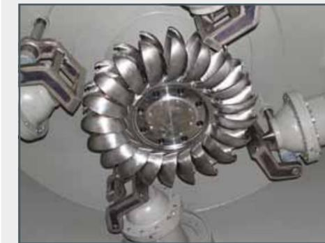
Rotor avec augets doubles comme aubes mobiles et tuyères à aiguille
