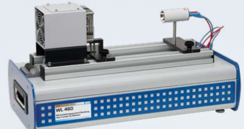
WL 460 Transfert de chaleur par rayonnement
