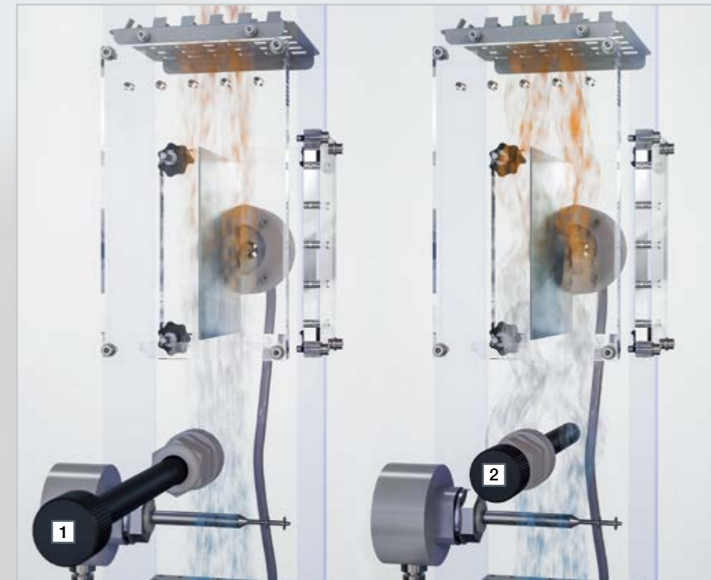
Plaque plane soumise à un écoulement incident
