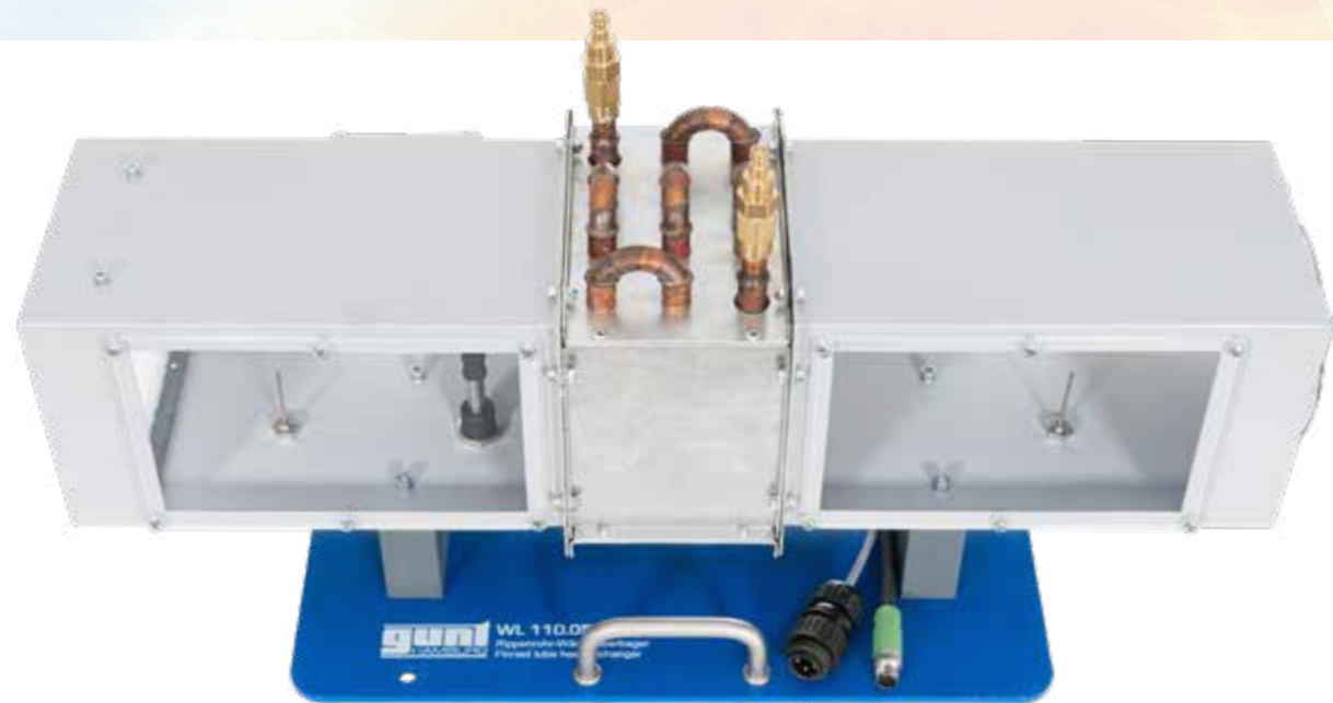
1 Luftkanal, 2 Rippen, 3 wasserführende Rohrleitung ■ kalte Luft, ■ Rohrleitung mit heißem Wasser
