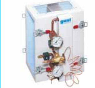
WL 312.03 Transfert de chaleur sur l'évaporateur d'agent réfrigérant
