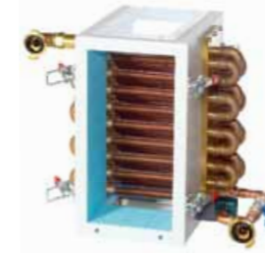
WL 312.02 Transferencia de calor en los tubos con aletas
