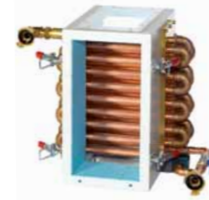
WL 312.01 Transferencia de calor en los tubos lisos
