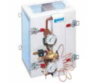
WL 312.03 Transferencia de calor en el evaporador para refrigerante
