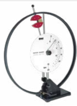
L'appareil d'essai compact WP 400 génère une capacité de travail de 25 Nm
