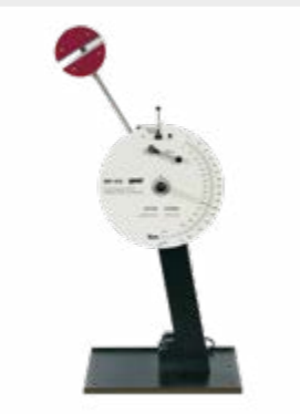
Le banc d'essai WP 410 génère une capacité de travail de 300 Nm
