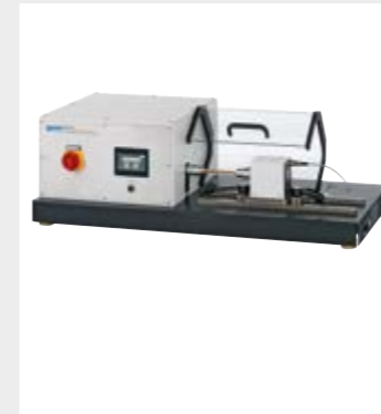
L'appareil d'essai WP 510 génère des moments d'essai de 200 Nm
