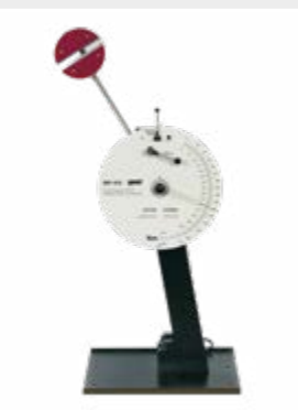
Der Versuchsstand WP 410 erzeugt 300 Nm Arbeitsvermögen
