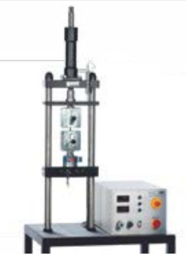
Der Versuchsstand WP 310 erzeugt 50 kN Prüfkraft
