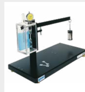
Das kompakte Versuchsgerät WP 600 ermöglicht Kriechversuche
