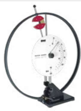
Das kompakte Versuchsgerät WP 400 erzeugt 25 Nm Arbeitsvermögen
