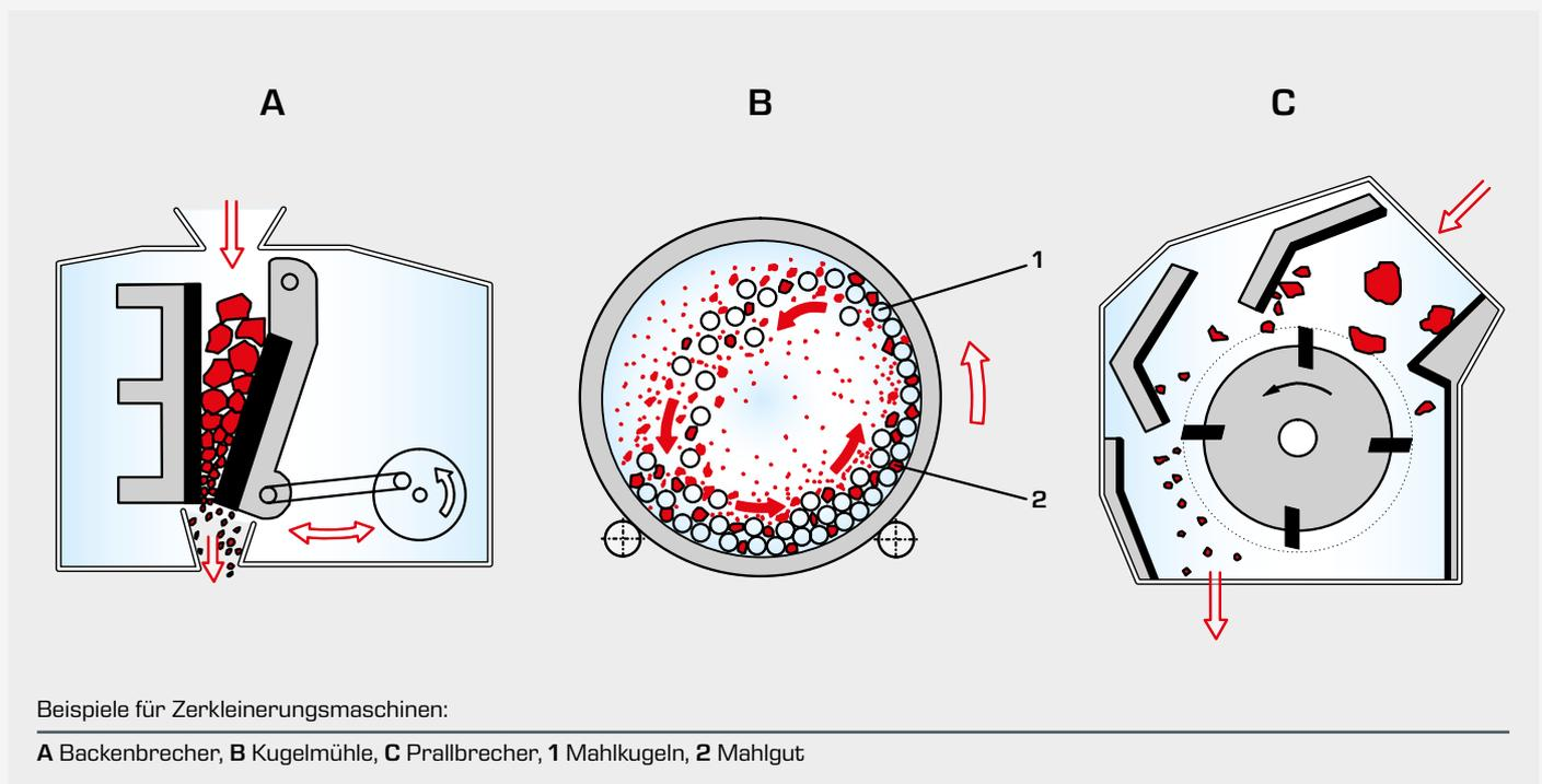
Das Ergebnis eines Zerkleinerungsprozesses hängt hauptsächlich von der angewandten Beanspruchungsart ab. Bei den meisten Zerkleinerungsmaschinen findet eine Beanspruchung zwischen zwei Festkörperflächen oder durch Prall statt:
