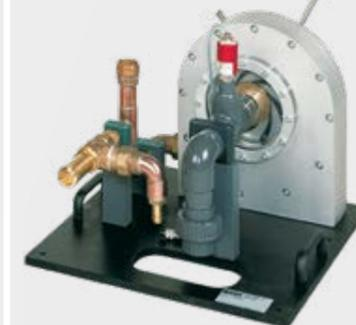
Dans la turbine Francis, la conversion de l'énergie de pression de l'eau en énergie cinétique s'effectue dans le distributeur et dans le rotor. La pression à l'entrée du rotor est supérieure à la pression à la sortie du rotor. Pour réguler la puissance de la turbine, on ajuste les aubes directrices.
