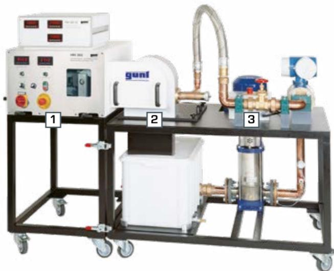
HM 365 fonctionne en mode générateur et freine la turbine par le biais d'une courroie trapézoïdale. La puissance générée est transformée en courant électrique par le générateur.
