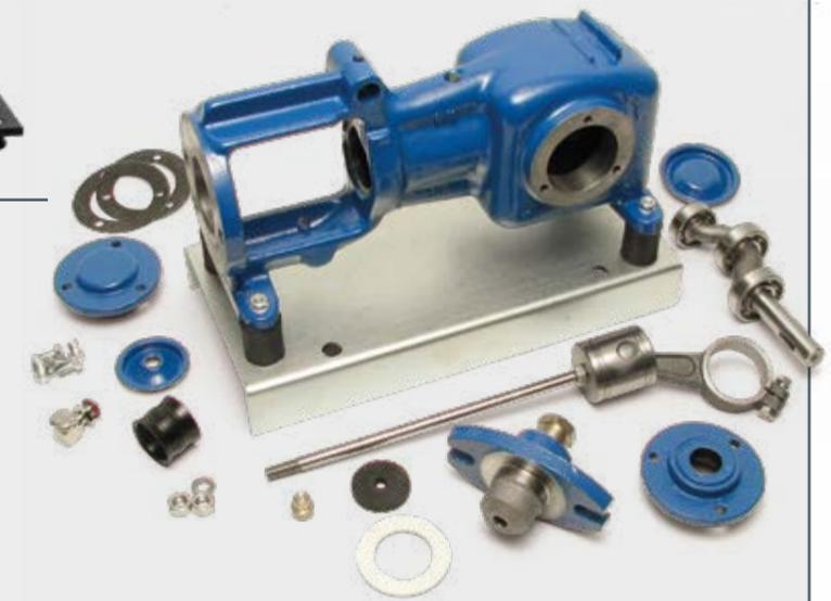
MT 184 Montage- und Instandhaltungsübung Kolbenpumpe
