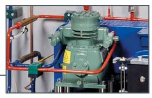
Le **compresseur** est l'unité motrice d'un système frigorifique à compression. Il extrait le réfrigérant gazeux de l'évaporateur, augmente sa pression et le transporte dans le condenseur. Le compresseur doit augmenter la pression du réfrigérant gazeux pour qu'il puisse se condenser dans le condenseur, libérant de la chaleur.
