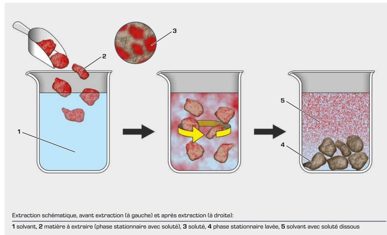
Afin d'obtenir une extraction aussi rapide et complète que possible, le solvant nécessite de grandes surfaces d'échange et des chemins diffusionnels courts. Ceci peut être obtenu par le broyage de la matière solide à extraire. Une granulométrie trop petite peut entraîner la formation de grumeaux et rendre le passage du solvant plus difficile.
