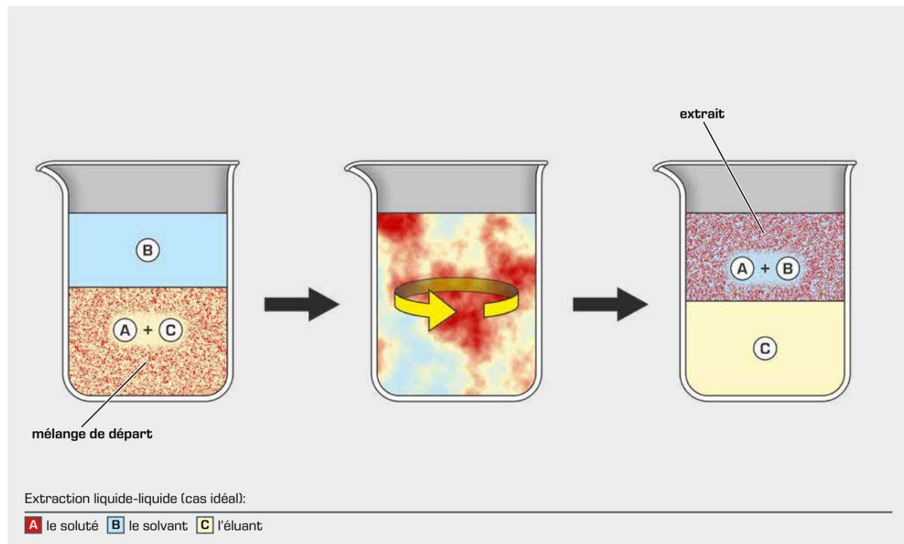
La représentation donnée en exemple représente la situation idéale dans laquelle le soluté A est complètement absorbé par le solvant. En réalité, il restera toujours un résidu du soluté dans l'éluant. De même, l'hypothèse d'insolubilité complète de l'éluant dans le solvant ne se vérifie pas toujours en pratique. Ainsi une partie de l'éluant est transféré dans le solvant.
