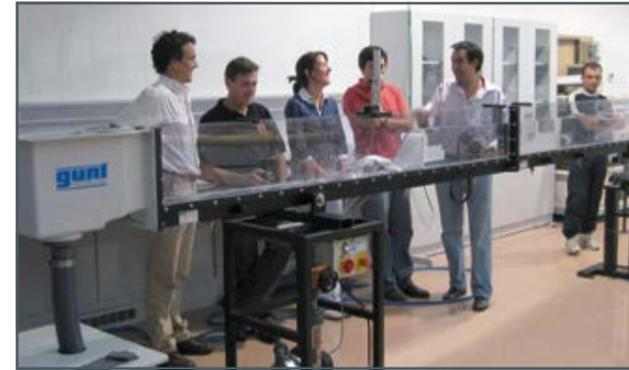
HM 160 est idéal pour l'introduction à la thématique de "l'écoulement dans des canaux ouverts" et la démonstration de nombreux principes de base. Ce canal est compact et prend peu de place.
