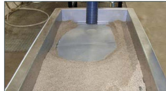
Piège à sédiments HM 160.72 dans le réservoir d'eau du HM 160 pour la collecte des sédiments
