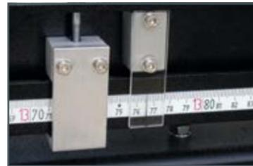
Échelle le long de la section d'essai
