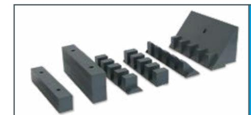
HM 162.35 Éléments de dissipation d'énergie
