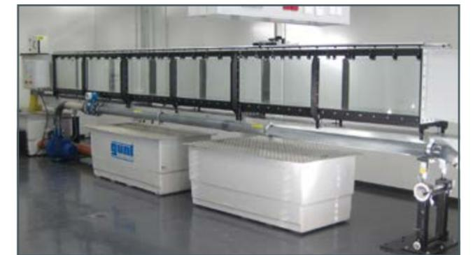
De par ses grandes dimensions (coupe transversale de 600x800 mm et section d'essai d'une longueur de 16m), le canal d'essai HM 161 GUNT le plus long offre de nombreuses possibilités pour la réalisation de vos propres projets de recherche.
