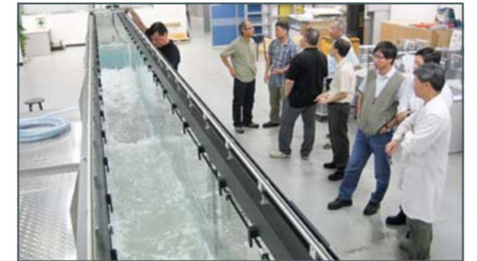
Les canaux d'essai HM 162 et HM 163 peuvent être fournis avec quatre longueurs différentes. Le canal d'essai "court" ayant une section d'essai de 5 m peut être installé très facilement dans des salles de laboratoire même petites. Avec des longueurs supérieures de section d'essai, la section d'observation en amont et en aval d'obstacles augmente.
