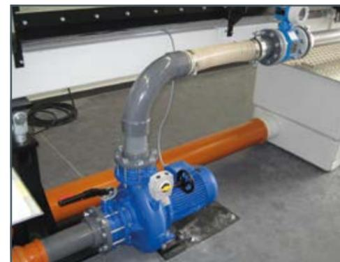
Pompe (HM 162) avec robinetterie d'arrêt à commande manuelle du côté de refoulement pour l'ajustage du débit (au-dessus de la pompe). Dans la conduite de refoulement de la pompe, on voit également le flexible et le débitmètre électromagnétique. La robinetterie d'arrêt est seulement nécessaire pour des essais avec des vagues.
