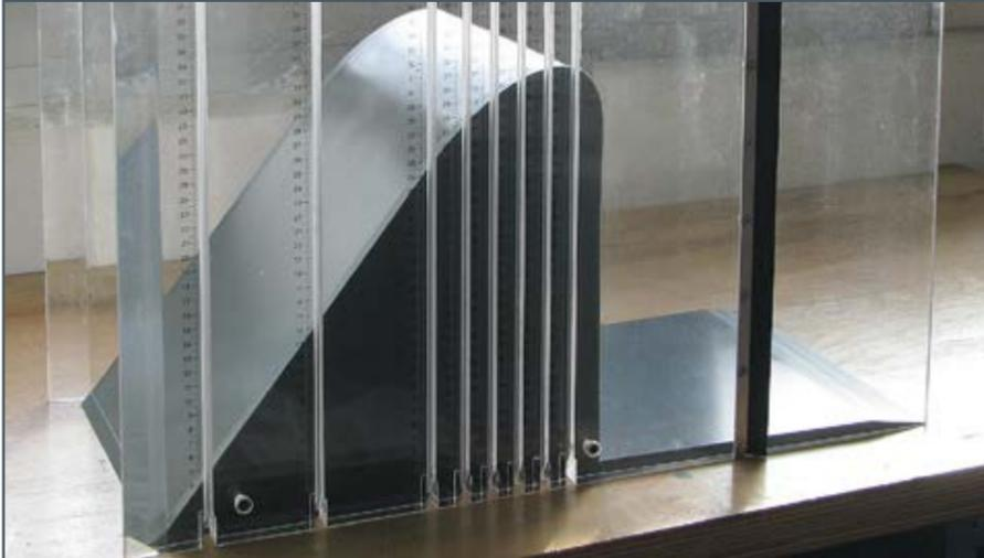
**Déversoir à crête arrondie avec points de mesure de la pression le long du dos de déversoir**
