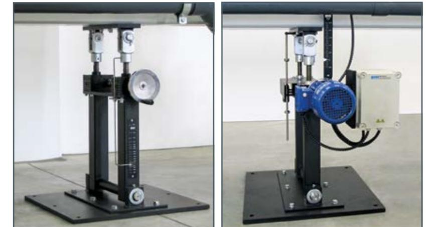
Système d'ajustage de l'inclinaison sur HM 162 et HM 163: à gauche système d'ajustage manuel de l'inclinaison, à droite système d'ajustage électrique de l'inclinaison HM 162.57
