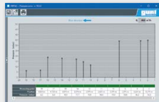
Verlauf der Druckhöhen entlang der Versuchsstrecke
