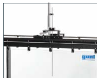
Wasserstandstaster HM 162.52 mit Instrumententräger
