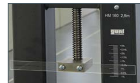
Neigungsverstellung bei HM 162 und HM 163: links manuelle Neigungsverstellung, rechts elektrische Neigungsverstellung HM 162.57
