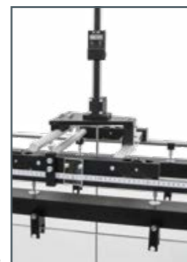
Digital-Wasserstandstaster HM 162.91 mit Instrumententräger
