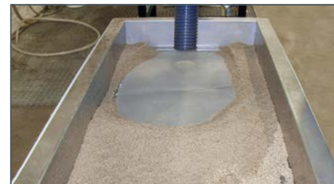
Sedimentfalle HM 160.72 im Wasserbehälter von HM 160 zum Auffangen des Sediments
