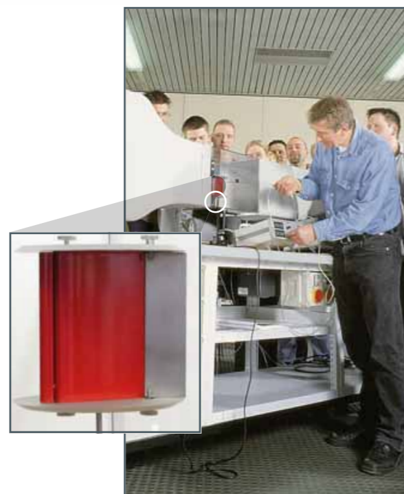
Mesure des forces de la portance et de traînée basée sur l'angle d'incidence d'une aile avec bec mobile et volet d'intrados
