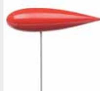
HM 170.08 Corps de résistance corps de ligne de courant longueur: 240 mm diamètre: 60 mm
