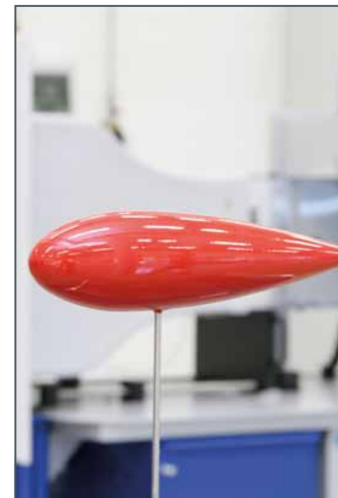
Messung von Auftriebs- und Widerstandskräften am Stromlinienkörper mit dem Zweikomponenten-Kraftaufnehmer
