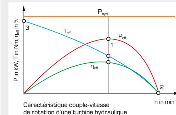
$P_{hyd}$  puissance hydraulique à l'entrée de la turbine,
