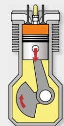
Le mélange comprimé air-carburant est allumé juste avant d'arriver au point mort supérieur. La pression qui se forme pousse le piston vers le bas.
