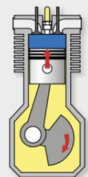
Le piston se déplace du point mort inférieur jusqu'au point mort supérieur. Ce qui a pour effet de comprimer le mélange air-carburant.
