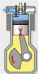
Le piston se déplace du point mort supérieur vers le point mort inférieur. Ce qui a pour effet d'aspirer le mélange air-carburant.
