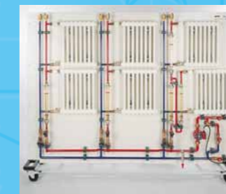
HL 305 Équilibrage des installations de chauffage
