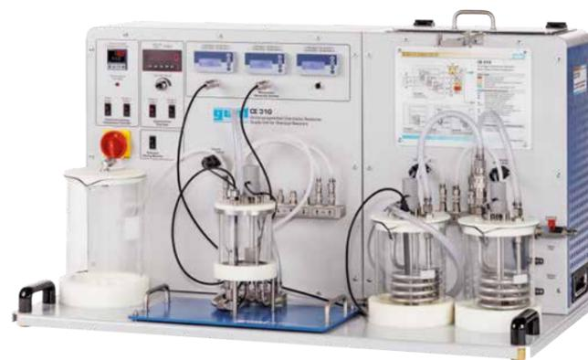
Versorgungseinheit Chemische Reaktoren CE 310 mit CE 310.01 Kontinuierlicher Rührkesselreaktor
