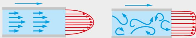
Profil de vitesse avec un écoulement entièrement formé
