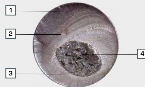
Évaluation de la surface de rupture après l'essai de résistance à la fatigue
