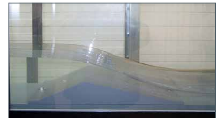
Déversoir cunéiforme HM162.33
