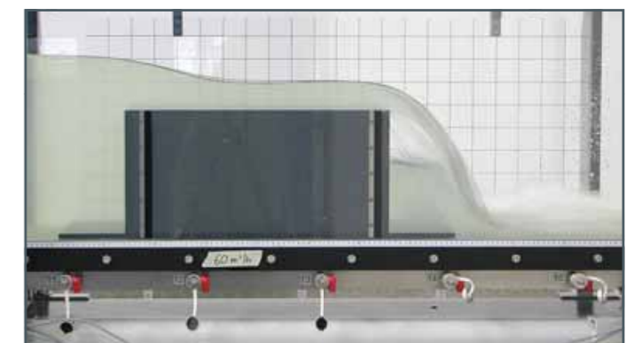
Déversoir à seuil épais HM162.31
