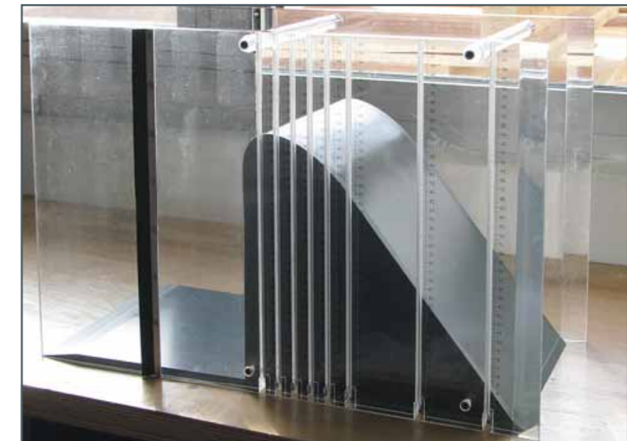
Distribution de la pression sur le déversoir à crête arrondie HM162.34
