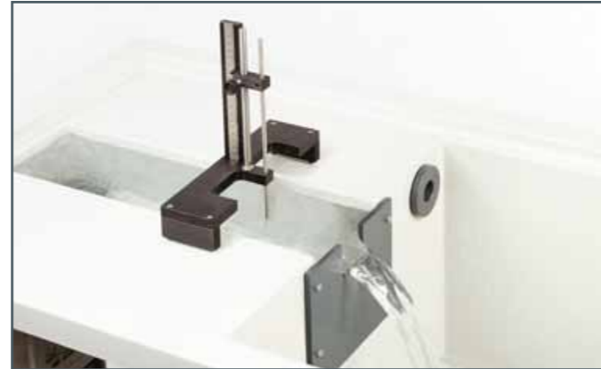
Déversoir à chute libre au niveau du déversoir de mesure
