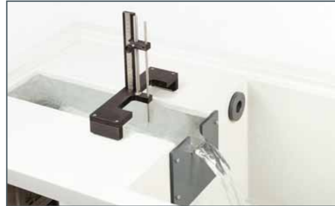
scharfkantiger Überfall am Messwehr
