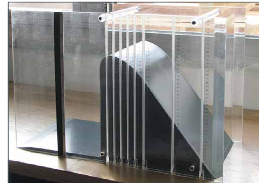
Druckverteilung am rundkronigen Wehr HM162.34
