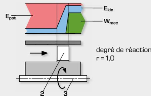
**Turbine exclusivement à réaction:** la transformation de l'énergie de pression potentielle en énergie cinétique a lieu uniquement dans une buse du rotor. La retenue de la buse fournit alors l'impulsion de travail mécanique. La turbine exclusivement à réaction n'est pas utilisée sur le plan industriel. L'illustration en montre une forme abstraite.
