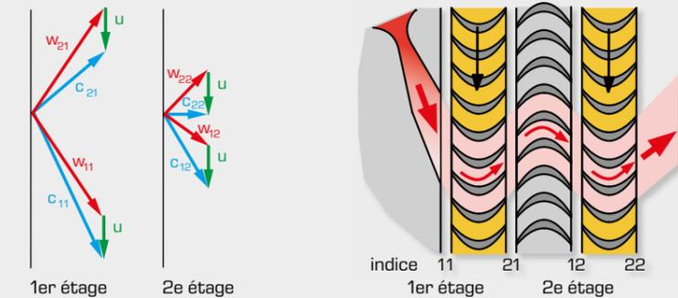
**Turbine à réaction avec étage de pression:**
