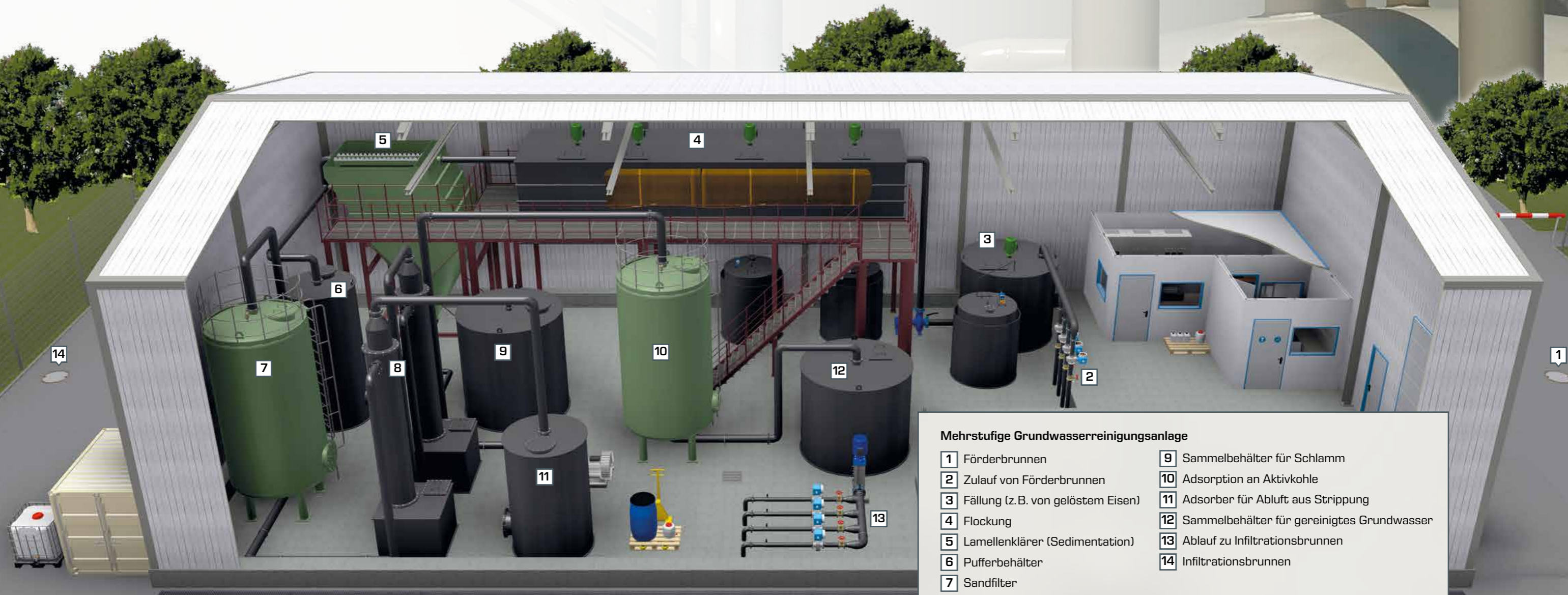
Förderbrunnen für kontaminiertes Grundwasser
