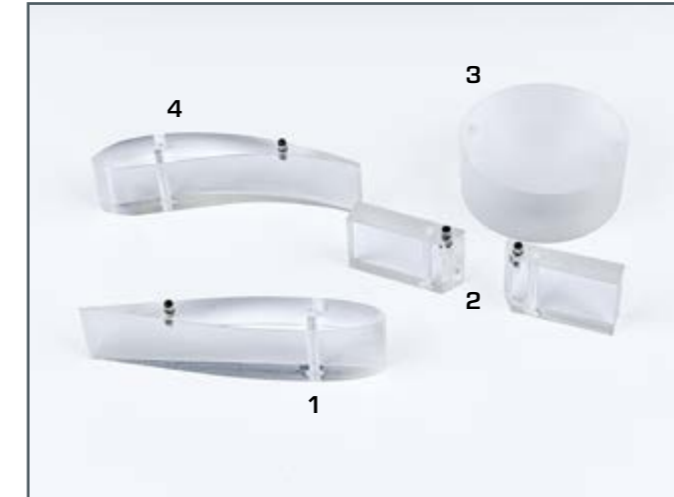
Modelle 1 Tragfläche, 2 Blende, 3 Zylinder, 4 Leitschaukelprofil
